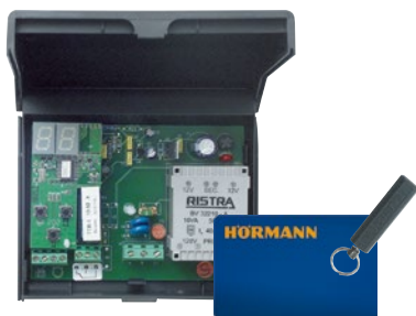
מקש שלט 1-TTR 1000 מיועד לפונקציה 1, באמצעות מפתח טרנספונדר או כרטיס טרנספונדר, ניתן לאחסן עד 1000 מפתחות או כרטיסים
