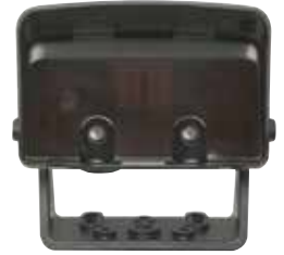
גלאי תנועה מכ"ם MWD-C פתיחת שער מהירה ומכוונת באופן אוטומטי, זיהוי כיוון, גובה מגנט מקסימלי 7 מטר, הרכבה באזורי הקפאה עמוקה אפשרית עד מקסימום -20^{\circ}\text{C} , IP 65
