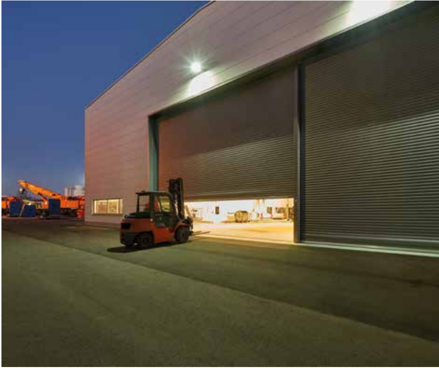
על ידי שילוב של כמה שערי גלילה/סורגי גלילה DD עם היחידה המרכזית הניתנת להזזה SSG DD, ניתן לסגור פתחים עד רוחב של 36 מ' ו- 9 מ' גובה.
